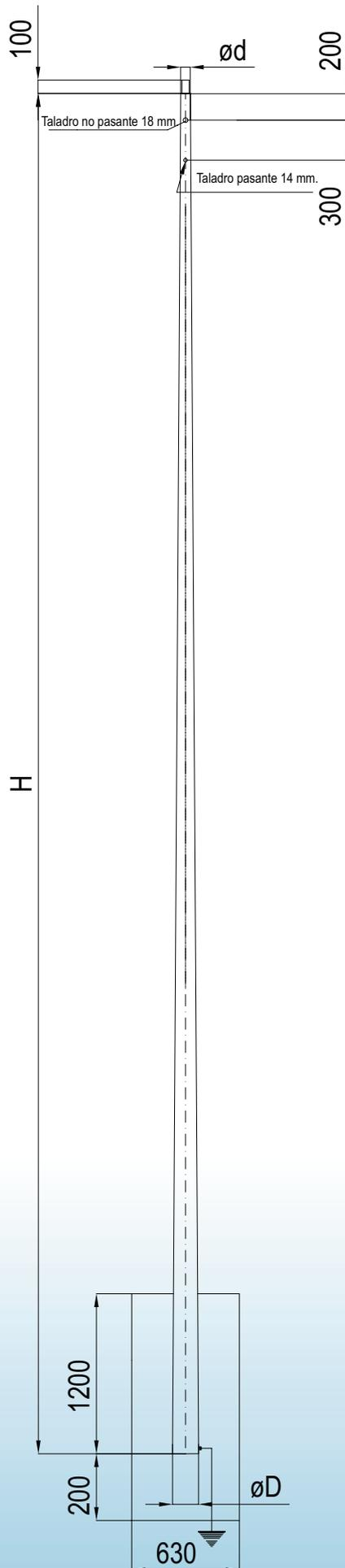
Fabricados en acero al carbono según Directiva de la Construcción 89 / 106 / CEE del Consejo de las Comunidades Europeas, del 21 de diciembre de 1988 y en base a la norma armonizada EN 40-5:2002 y galvanizados por inmersión en caliente. Los fustes son troncocónicos de sección circular de una sola pieza (hasta un desarrollo de 14 metros). Todas las soldaduras son de características mecánicas superiores a las del material base
